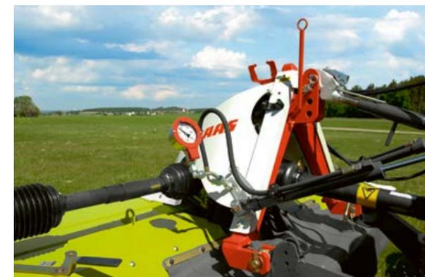
Optionale hydraulische Entlastung ACTIVE FLOAT für Frontmähwerke.
