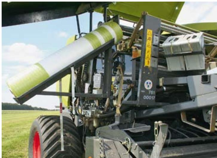
*Auf der Schurre lässt sich eine Reserve-Netzrolle transportieren. Zum Rollenwechsel kann sie vor die Netzaufnahme geschwenkt werden, das soll den Fahrer entlasten.*
