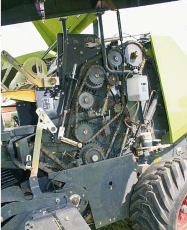
Die neuen Pressen sind mit verstärkten Ketten und Getrieben und besonders verschweißten Presswalzen auf hohe Leistungen und maximalen Durchsatz getrimmt. Der Schmierölvorrat wurde auf sechs Liter vergrößert.
