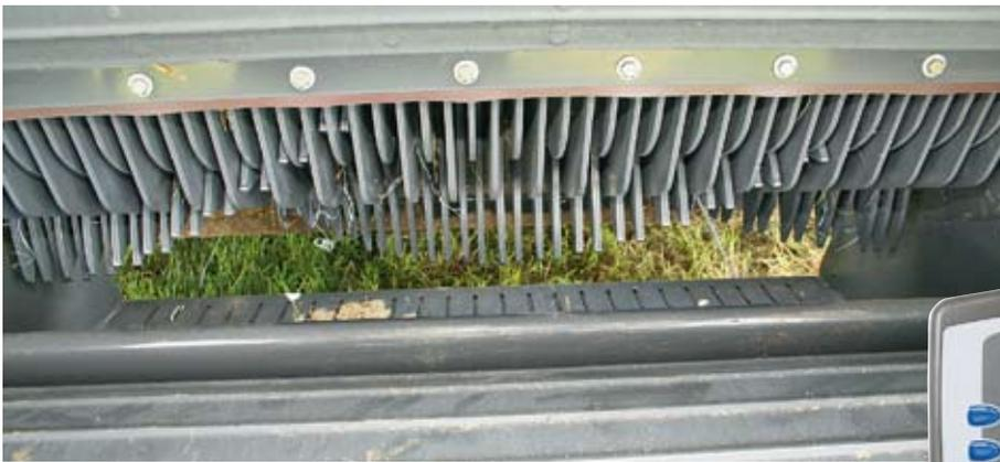
ohne dass der Einzug gleich verstopft. Die Schnittqualität soll unter diesem Vorgang nicht leiden. Jede Auslenkung des Bodens wird übrigens im Communicator optisch und akustisch angezeigt, so kann der Fahrer schnell reagieren.
