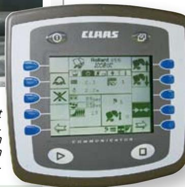
Weiterentwickelt wurde auch die hydraulische Verriegelung der Presskammer. Diese Lösung ermöglicht drei variable Ballengrößen zwischen 1,25 und knapp 1,35 m trotz fester Kammer. Ein Impulsgeber und ein Sensor an der rechten Heckklappenseite steuern die Hydraulikzylinder, die für die Klappenschließung zuständig sind. Derweil informiert eine Anzeige im Communicator den Fahrer über die aktuelle Einstellung.
